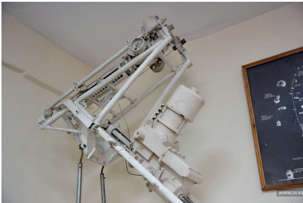
«Луна-24» космос аппаратынын Кыргызстанда жасалган бургулоочу механизминин макети
